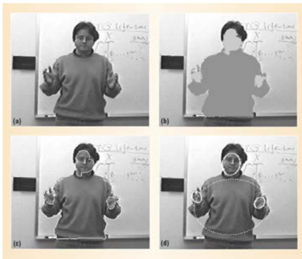
Figura 4 – Passos iniciais em reconhecimento de gestos: (a) imagem original, (b) extração da região, (c) contorno, (d) adequação da elipse
