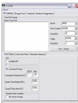
Figura 14. Tela do Programa X-CTU – Configuração ZigBee
