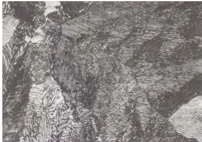
Figura 2.5 – Aspecto micrográfico da perlita. Aço eutetóide. Ampliação de 1000 vezes [2].
