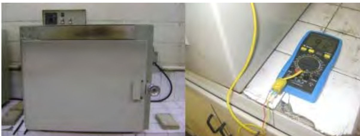
Figura 3.2 – Forno tipo mufla e controle de temperatura.
