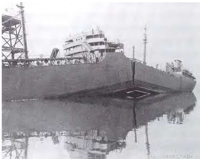
Figura 1.1 – Casco de um navio T2 Tanker, dividido em dois em função do material ter sido fragilizado em função da baixa temperatura [11].
