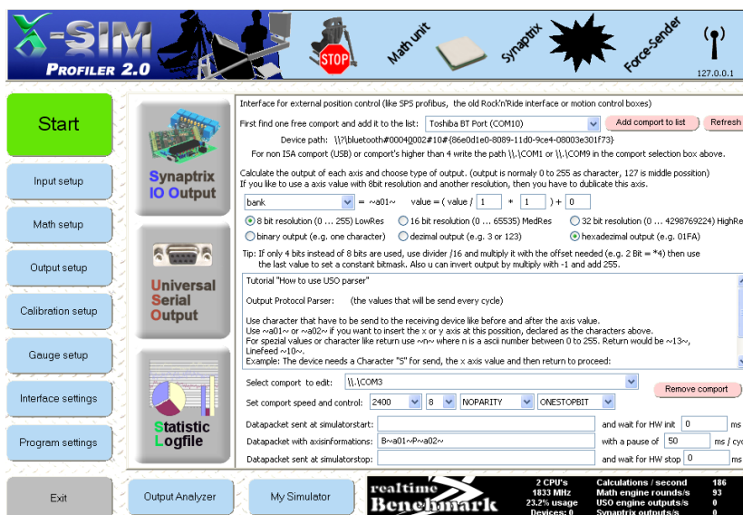
Figura 26: Tela de configuração da saída serial do software X-Sim Force-Profiler
