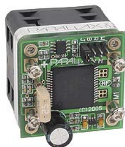
Figura 15: Ponte HB-25 Parallax
