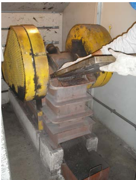
Figura 7: Britador de mandíbulas e separador de calhas [Fonte: RMRS (2007)]
