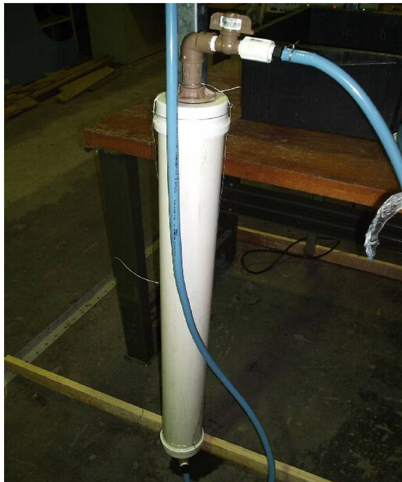
Figura 22 - Aparelho para retirar as bolhas da tubulação
