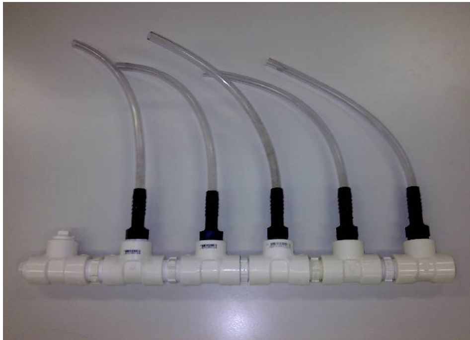
Figura 15 - Protótipo para a alimentação hidráulica
