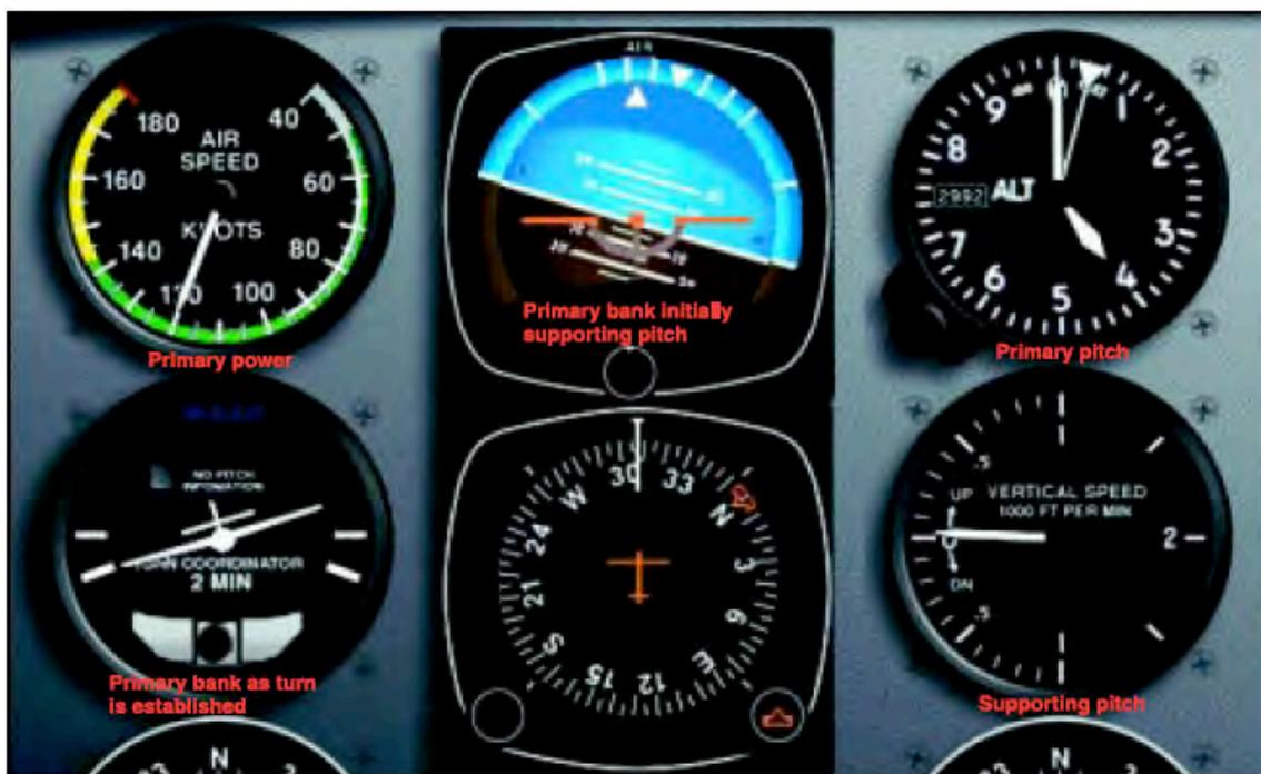
**Figura 18** – Curva cronometrada com velocidade constante
