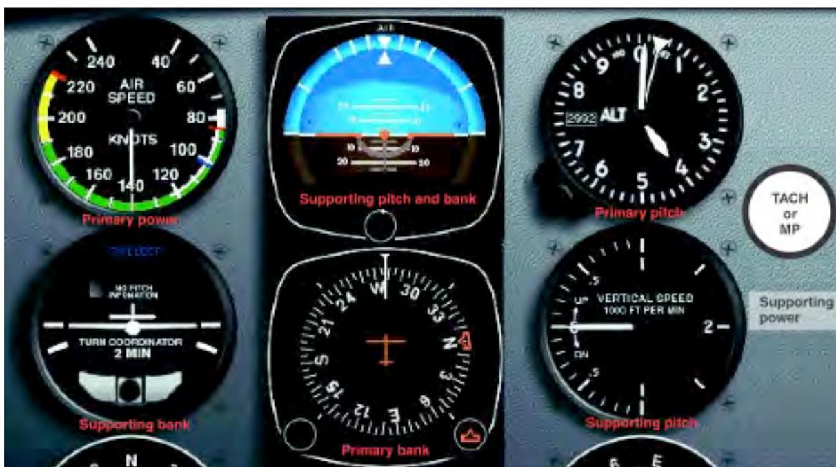
Figura 14 – Vôo em linha reta horizontal (velocidade normal de cruzeiro)
