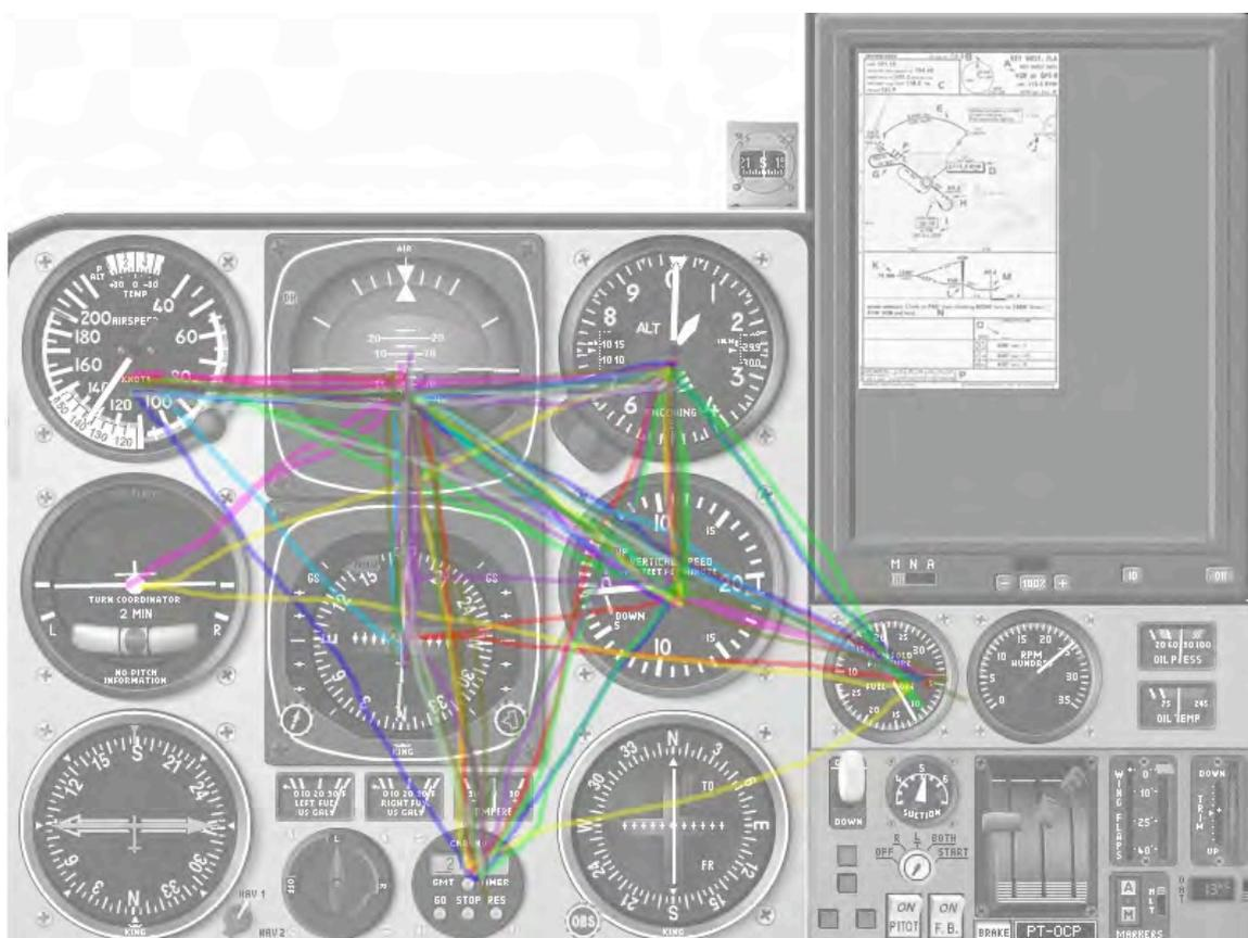
**Figura 24** – Padrões de *scan* sobrepostos na descida com razão e velocidade constantes
