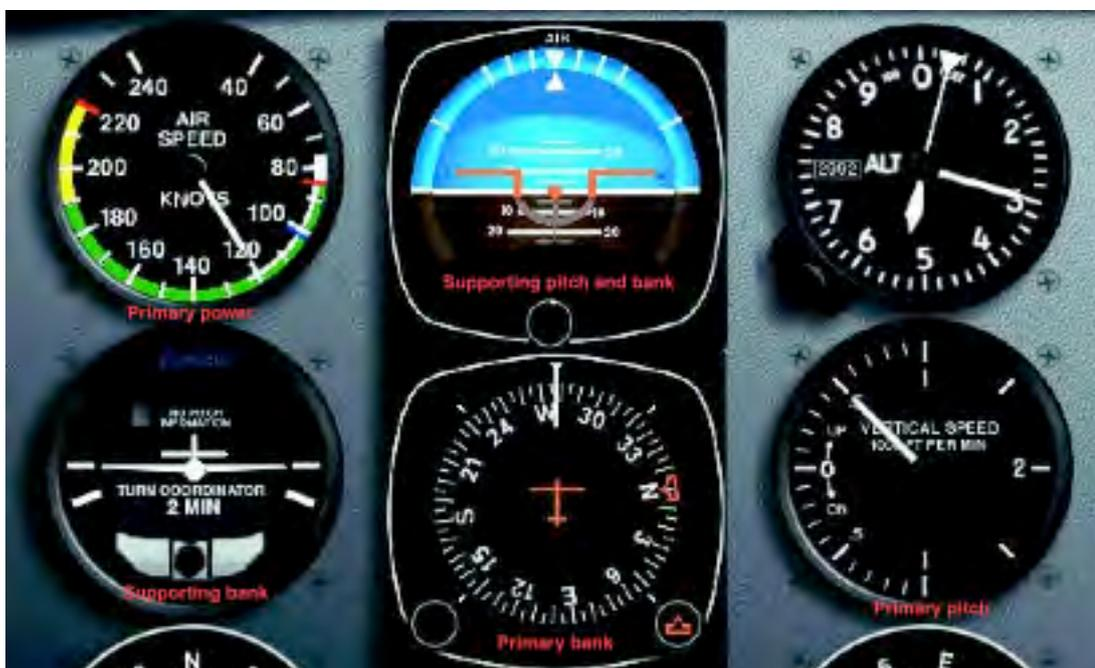
**Figura 16** – Subida estabilizada com razão de subida constante
