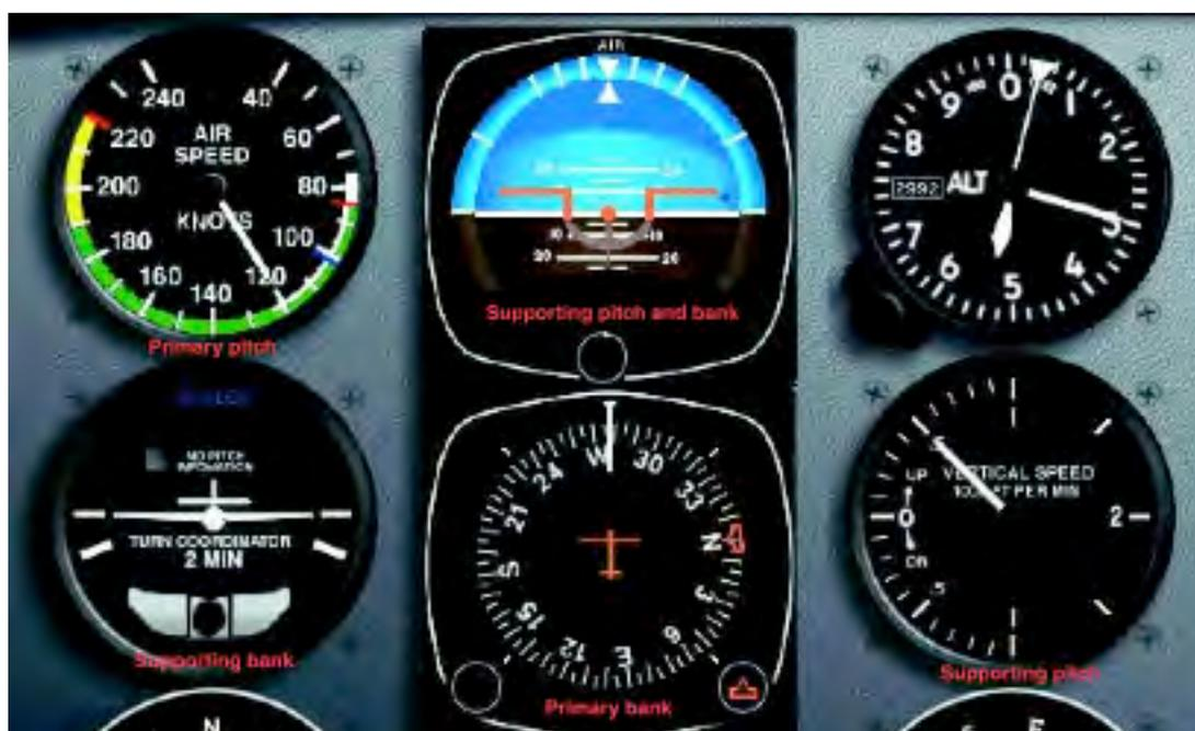
**Figura 15** – Subida estabilizada com velocidade constante
