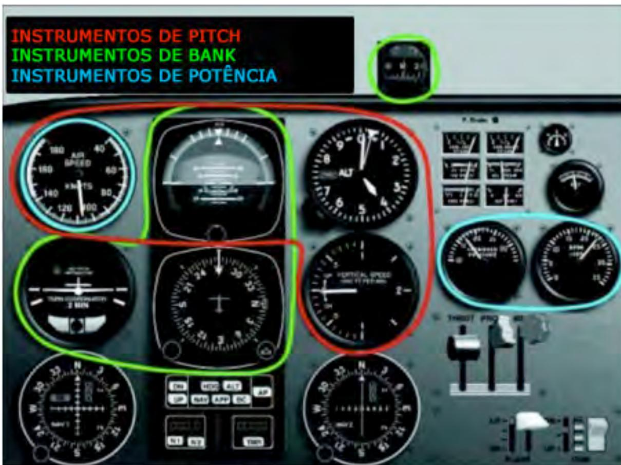
**Figura 10** – Método de instrumentos primários e de suporte
