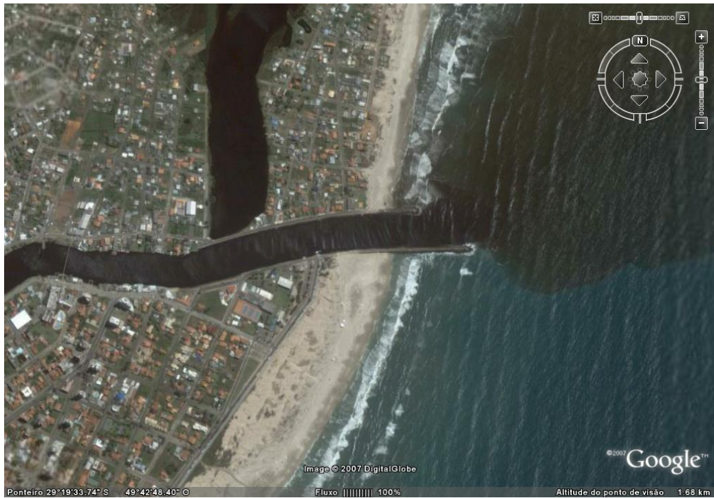
Figura 4 - Imagem da Foz atual do Rio Mampituba, visualizamos os guias de corrente, os molhes, o braço morto na parte superior a esquerda e a barra arenosa hoje urbanizada em Passo de Torres (SC), formada após a obra. O braço morto como resultado da migração da desembocadura em tempos pretéritos.
