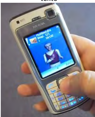
Figura 82 - SMS to Sign Language for Mobile Phones : tradução em sinais da mensagem de texto
