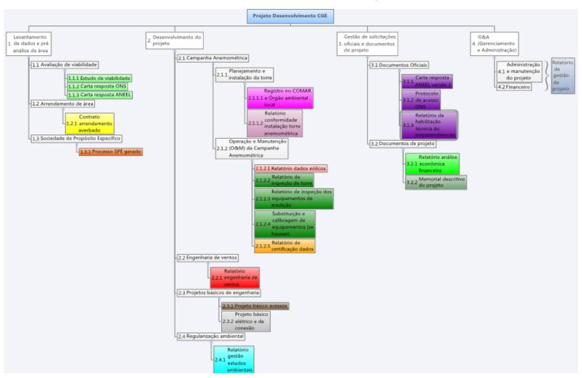
Figura 7 – Estrutura Analítica de Projeto indicando as fases, subfases e produtos de projeto.
