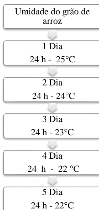
Figura 3 – Fluxograma do processo de umidade do grão de arroz.
