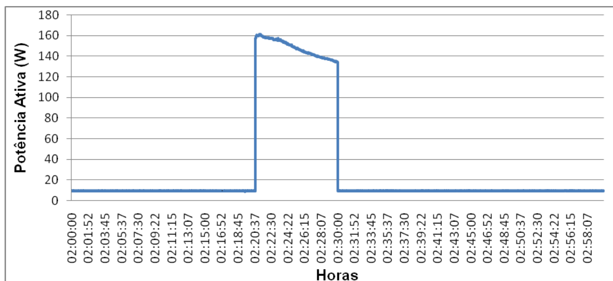
Figura 4.5. Curva de carga reproduzida através de dados capturados do protótipo, focando período durante a noite, onde apenas equipamentos em modo standby e refrigerador permanecem ligados.
