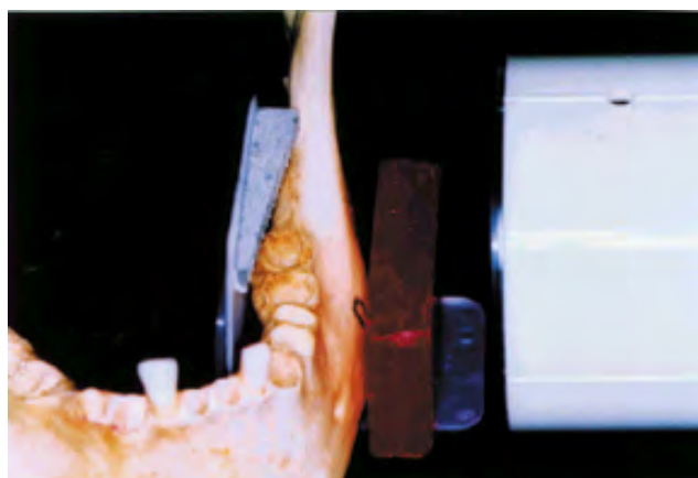
Figura 2 – Tomada radiográfica exibindo o conjunto, filme, simulador e penetrômetro, paralelos entre si e com incidência perpendicular do feixe de radiação.
