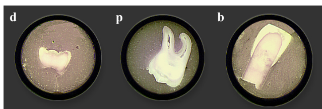
Figura 1 – Imagem representativa dos corpos de prova usados para os testes de dureza superficial: (d) dente humano decíduo; (p) dente humano permanente; (b) dente bovino.
