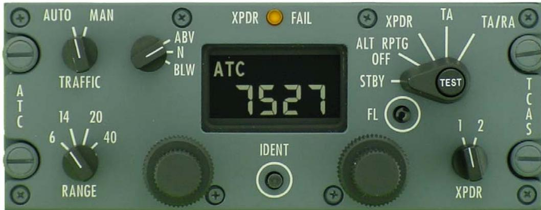
Figura 5.1.1.3.1 - Painel de Controle ATC Modo S/TCAS
