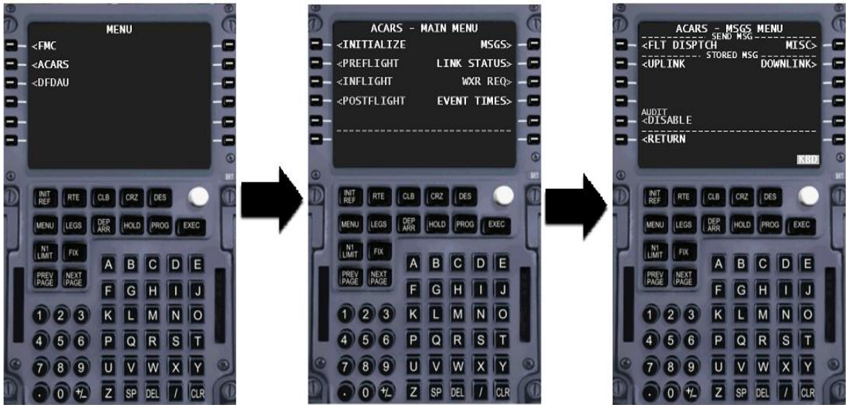
Figura 8 - ACARS acoplado ao FMS; Inicialização à página de mensagens Fonte: O autor (2010)
