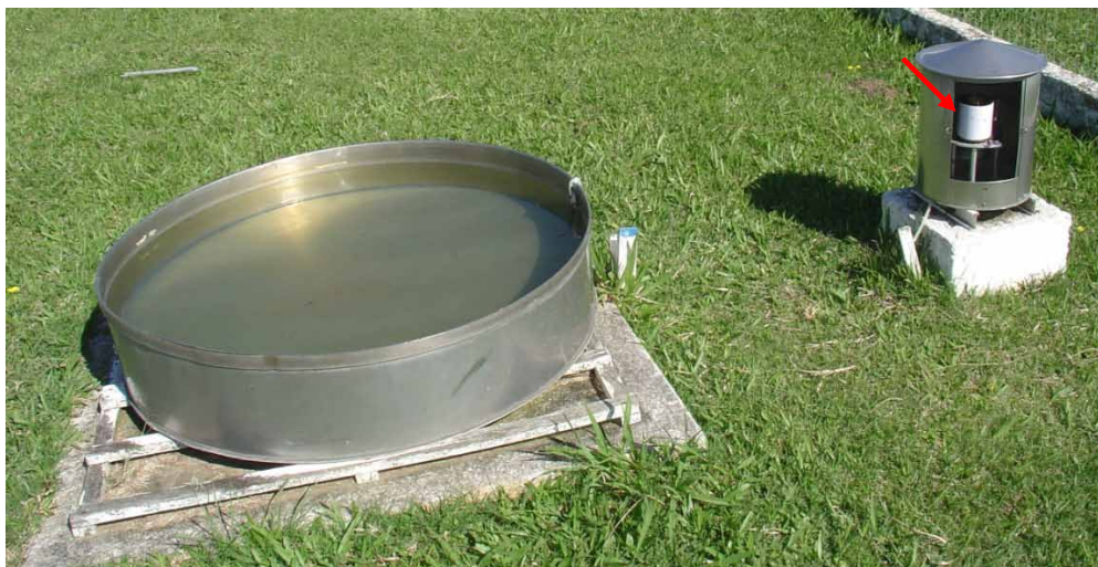
Figura 9: Tanque de Classe “A”, detalhe mostrando equipamento responsável pelo registro dos dados semanais do tanque classe “A”. Fonte: O Autor (2010).
