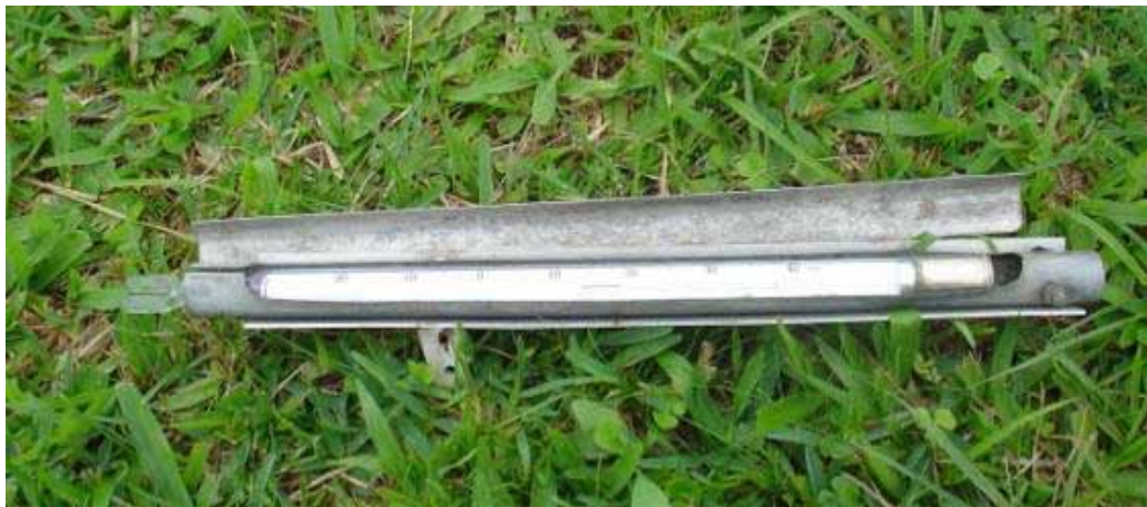
Figura 8: Termômetro da relva, instalado ao nível do solo. Fonte: O Autor (2010).
