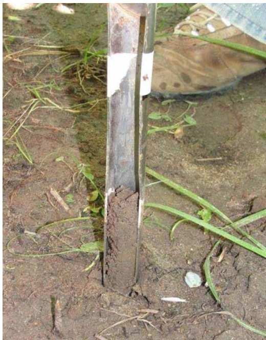
Figura 20: Amostra de solo sendo retida com o auxílio de um trado na profundidade de 10 cm, para a determinação da umidade do solo na camada de 0 – 50 cm.
