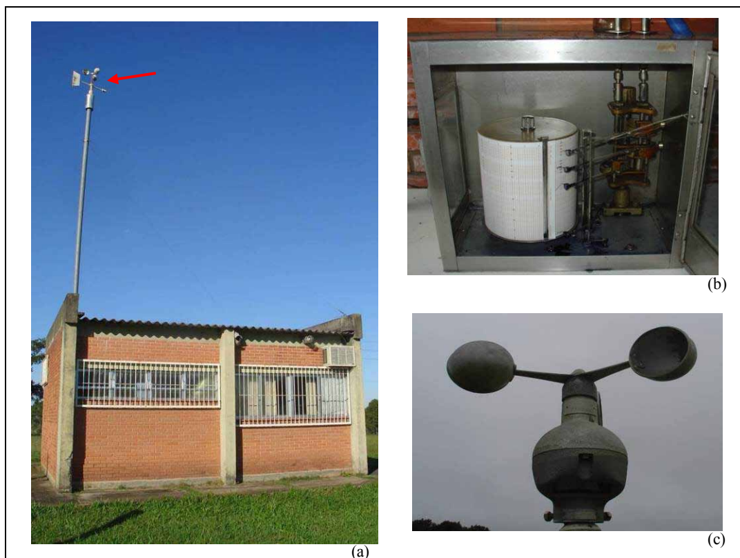
Figura 4: Equipamentos utilizados para determinar a velocidade e direção dos ventos, detalhe mostrando sensores Catavento tipo Wild, instaladas a 10 m de altura (a); tambor de registros (b); anemômetro de canecas (c). Fonte: O Autor (2010).
