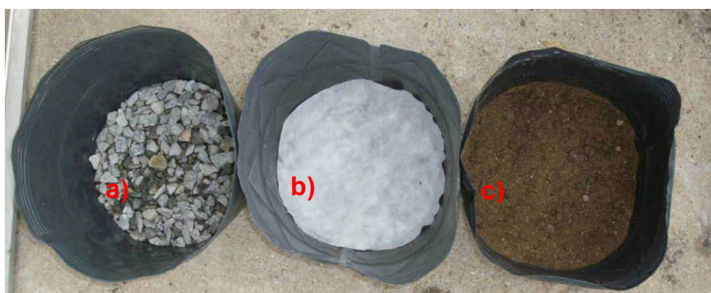
Figura 22: Montagem dos vasos para implantação do experimento, britas no fundo do vaso (a), “TNT” sobre as britas (b) e vaso com terra sobre o “TNT e as brita (c). Fonte: O Autor (2010).
