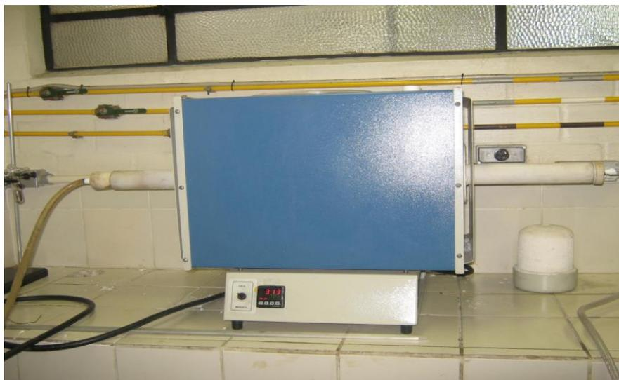
Figura 2: Forno Elétrico (marca Sanchis Fornos Elétricos).
