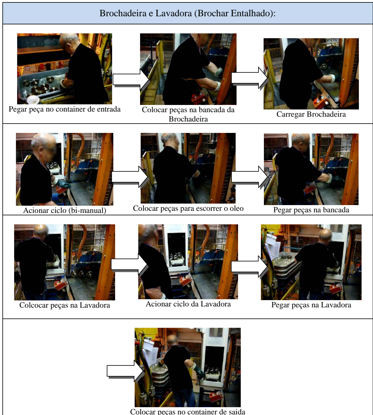
Quadro 8 – Sequência de atividades desenvolvidas na operação Brochar Entalhado
