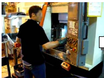
Acionar ciclo do Centro de Usinagem
