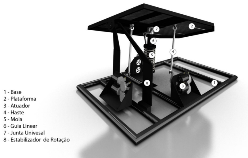
Figura 10 – Sistema de movimento e estabilização do cockpit
