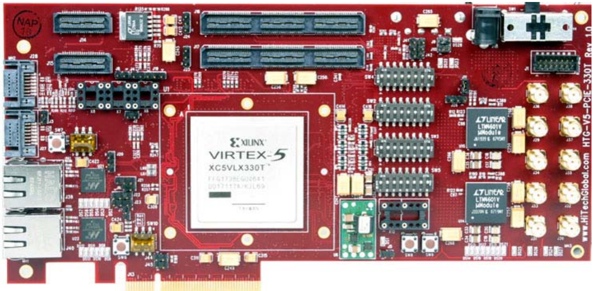
Figura 51 - Plataforma de Prototipação HTG-LX330T, com FPGA Virtex-5 330T
