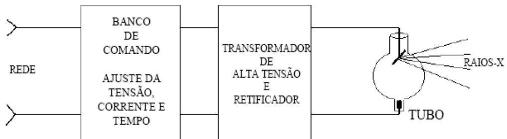
Figura 1: Representação esquemática de um equipamento de raios X.
