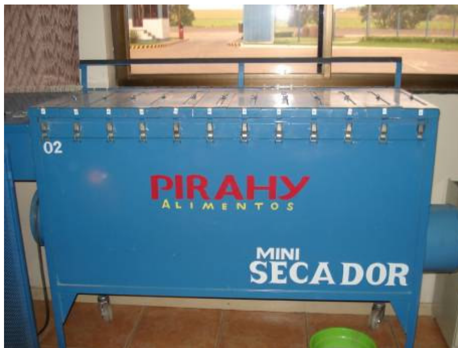
Figura 30 - Mini secador usado no laboratório de classificação. Fonte: O autor (2008)
