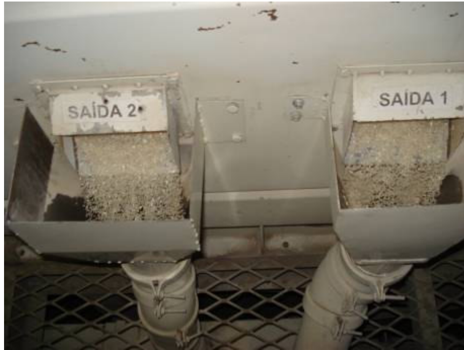
Figura 59 – CPRZ, saída 1 grão \frac{3}{4} e saída 2 o canjição. Fonte: O autor (2008).
