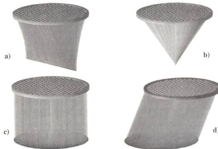
Figura 2: Tipos de Colimadores: a) Feixe em leque ( Fan Beam ); b) Feixe em Cone ( Cone Beam ); c) Orifícios Paralelos ( Parallel Hole ); d) Feixe com deflexão ( Slant hole ). Fonte: SILVA (2004).
