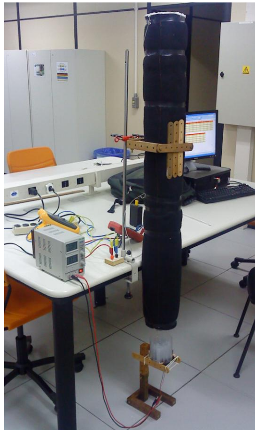
Figura 12: Foto do aparato experimental para determinação do coeficiente de convecção.
