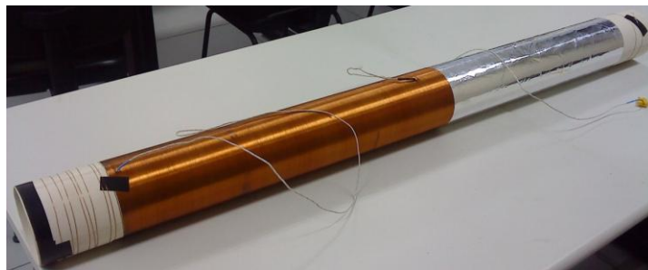
Figura 5: Foto mostrando parte do enrolamento com fio de cobre envolvido com papel alumínio.
