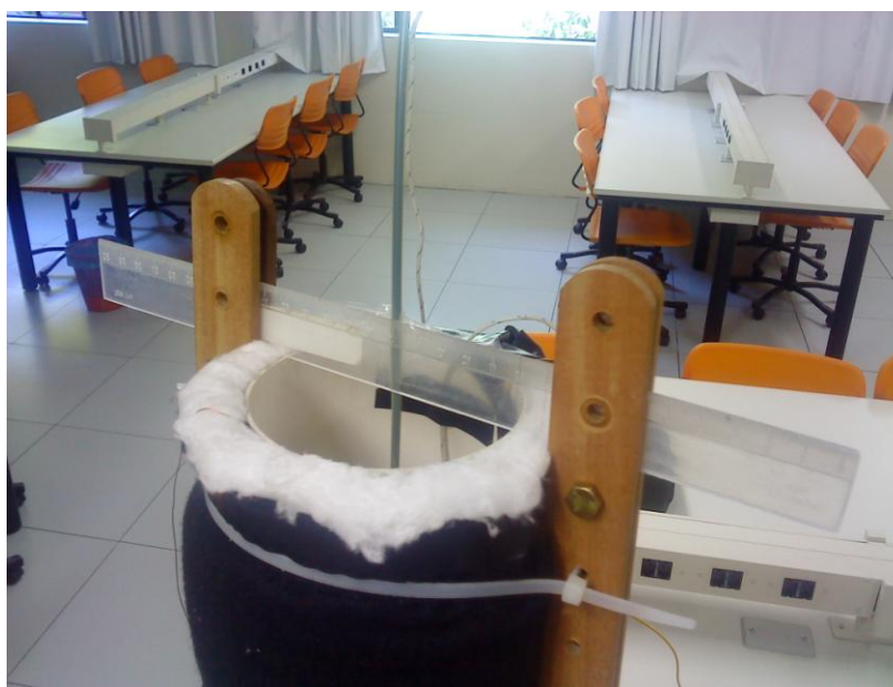
Figura 13: Foto do termopar móvel acoplado na base de madeira, para medir a temperatura de saída do ar.
