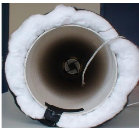
Figura 10: Foto do ventilador em funcionamento, fixado numa das extremidades do cano de PVC.
