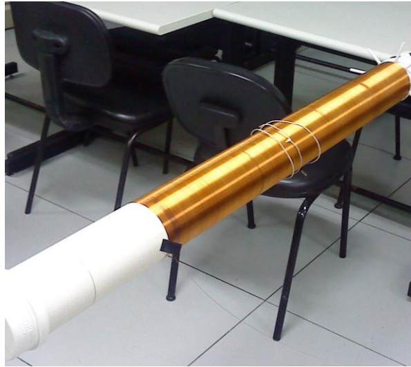
Figura 4: Fio de cobre esmaltado parcialmente enrolado ao longo da parte central do cano de PVC.
