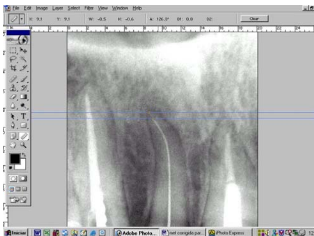
Figura 3 – Barras horizontais e ferramenta de medição para aferição da ponta do instrumento ao vértice radiográfico em oblíquo no programa Photoshop 7.0.
