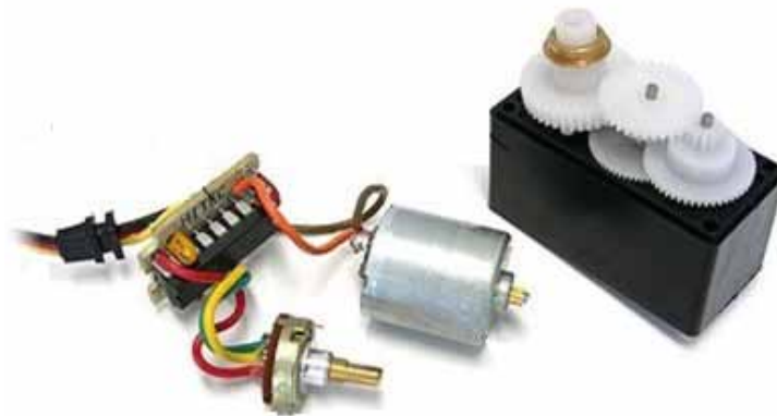
Figura 1: Exemplo de componentes de um servomotor
