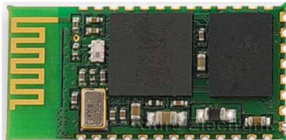
Figura 13: Foto do módulo Bluetooth Sure Electronics.
