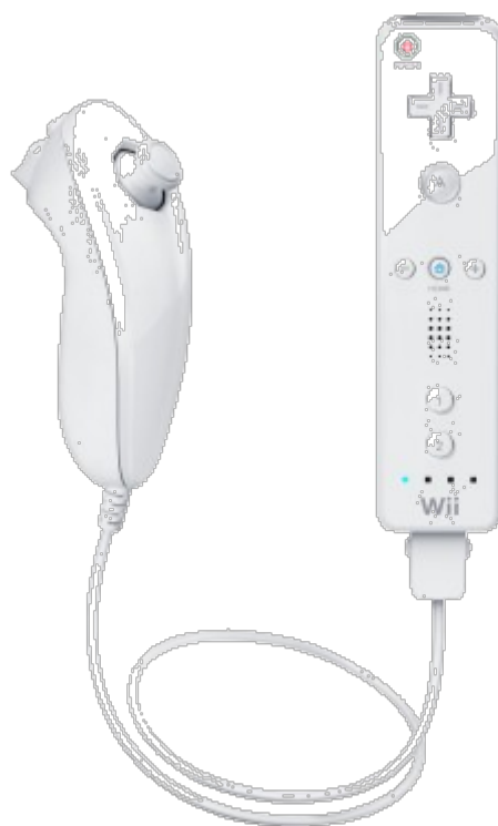
Figura 16: Wiimote a direita, com o nunchuck conectado.
