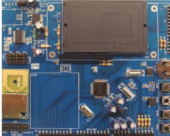
Figura 6: Placa de Laboratório de Processadores com MSP430 utilizada.
