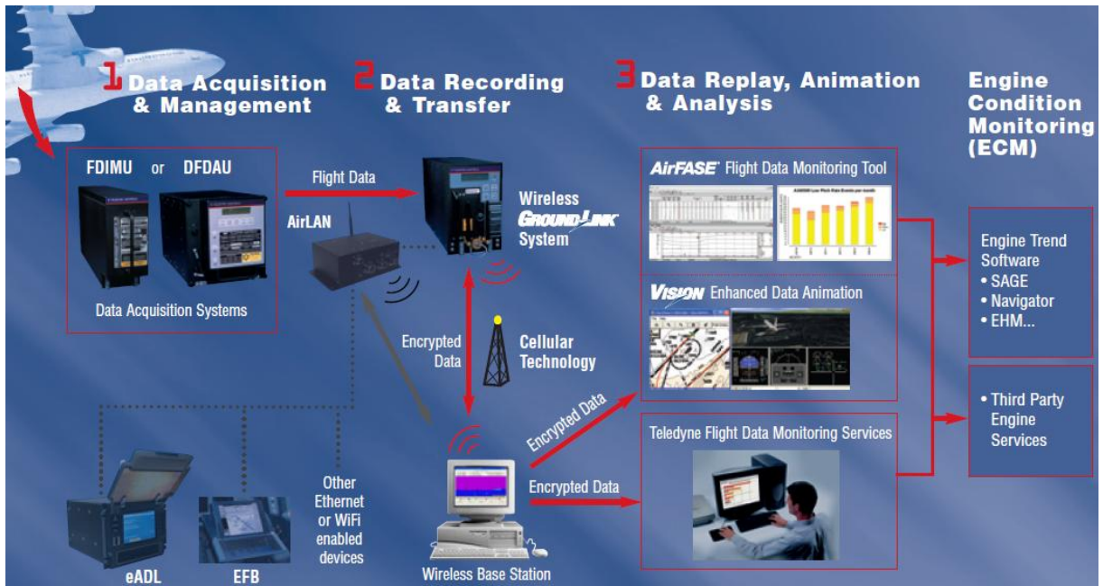
Figura 3.5.1: Diagrama Sistemático Completo do Programa FOQA da Teledyne Fonte: Teledyne Controls (2009).
