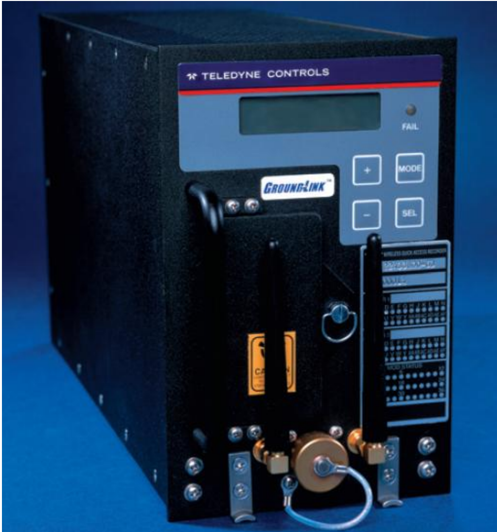
Figura 3.3.3: Transmissor Sem Fio ( Groundlink ) da Teledyne Fonte: Teledyne Controls (2009).
