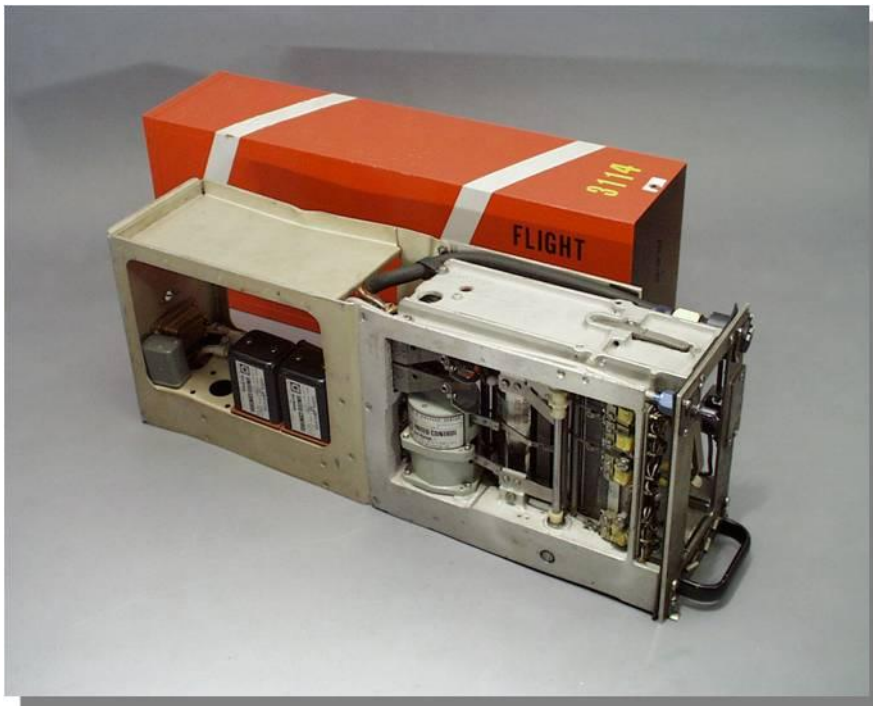
Figura 2.1.4: Flight Data Recorder (FDR) da Sundstrand modelo 542 Fonte: Grossi (1999).
