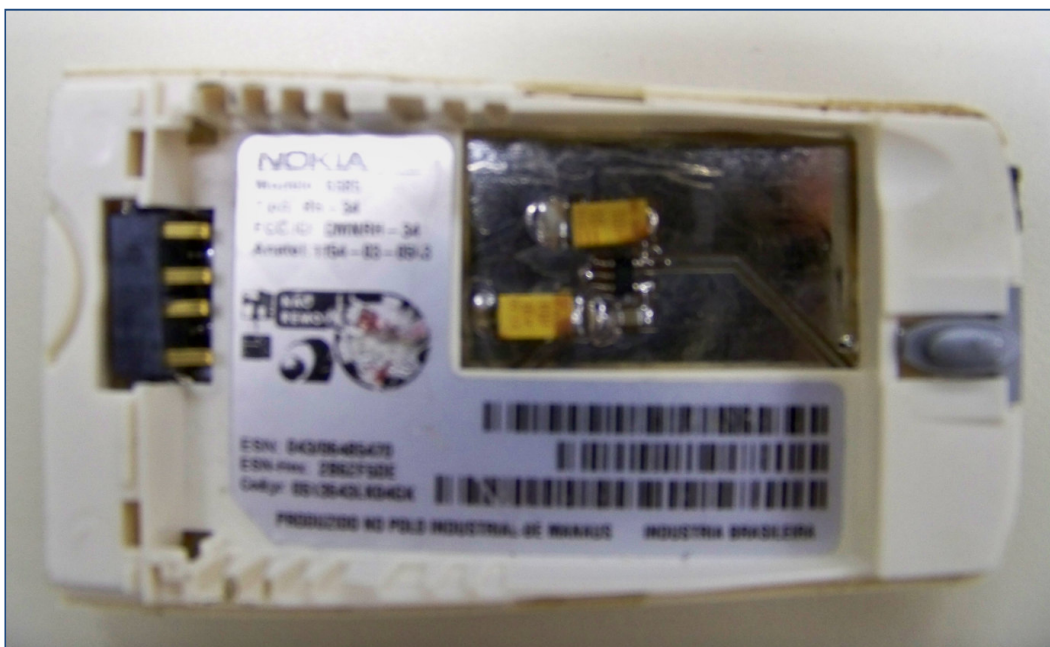
Figura 10 – Adaptação para alimentação com regulador de tensão LP 2985 de 3,3 volts. Fonte: O autor (04/05/2009).
