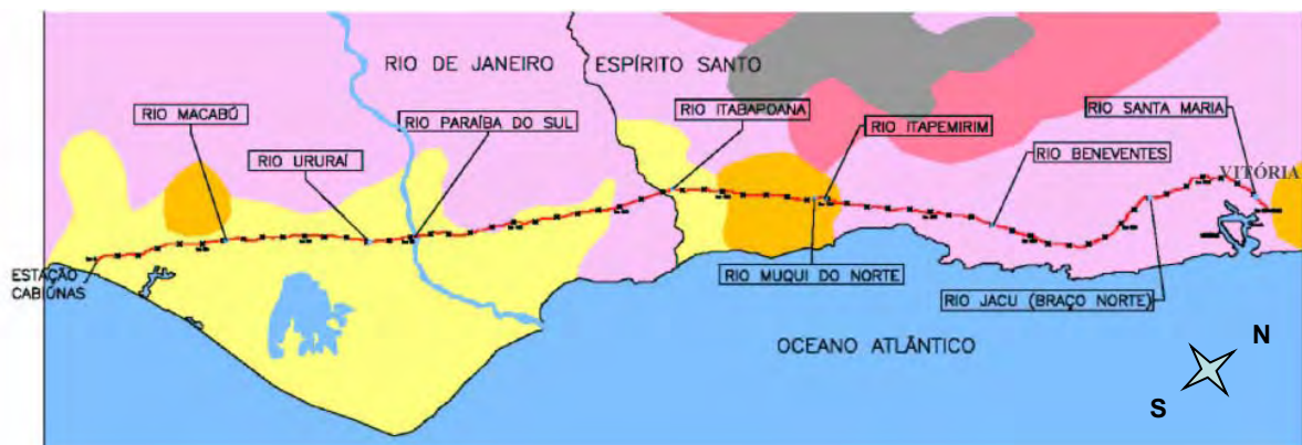
Figura 12 – Estudo geológico-geotécnico e definição de 9 travessias subaquáticas em perfuração direcional do gasoduto Cabiúnas-Vitória (GASCAV) do projeto GASENE (Projeto do Gasoduto de Interligação Sudeste Nordeste) Fonte: modificado de Kochen ([2008])
