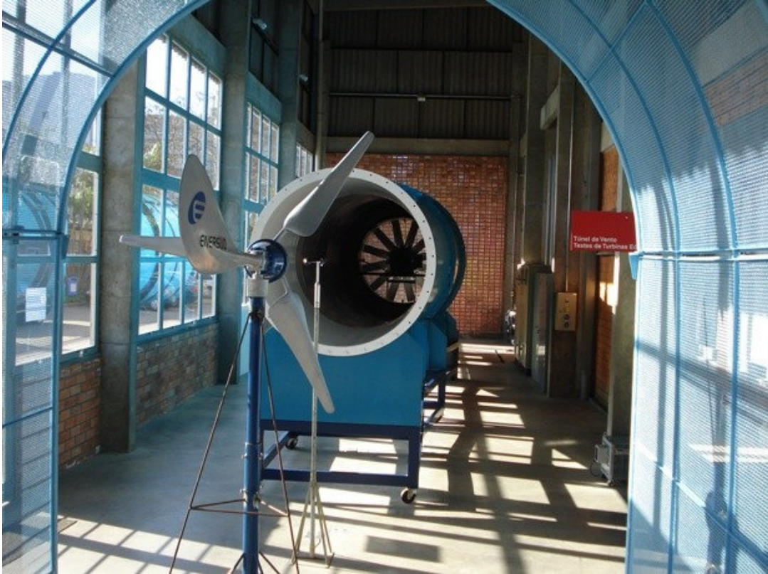
Figura 36 - Montagem da turbina para teste
