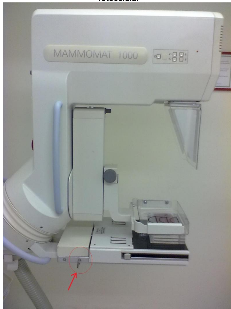
Figura 14: Braço rotatório em C, onde a seta vermelha indica a posição escolhida para a fotocélula.
