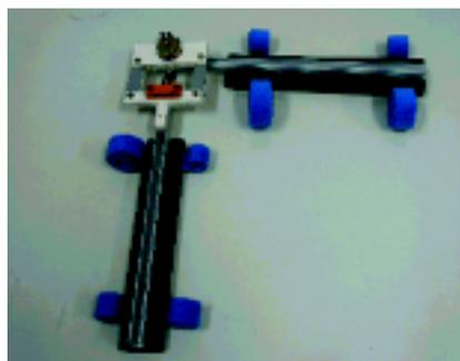
Figura 1 - Eletrogoniômetro utilizado para mensurar a variação angular do joelho.
