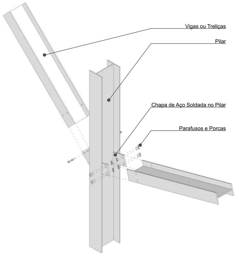
ENCONTRO PILAR E VIGAS - ISOMÉTRICA - Esc. 1:25
