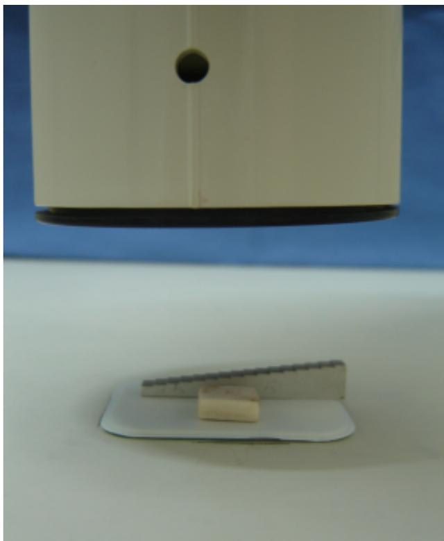
Figura 2 – Tomada radiográfica apresentando o posicionamento do fragmento e do penetrômetro sobre o filme radiográfico.
