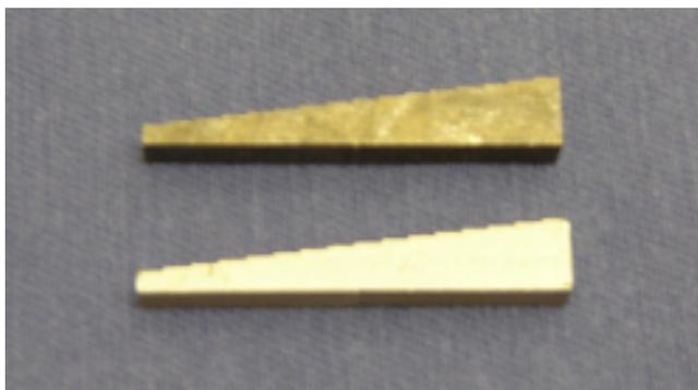
Figura 1 – Penetrômetro de alumínio.
