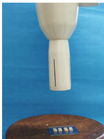
Figura 3 - Disposição dos corpos de prova para tomada radiográfica: A - Amostra na posição A; B - Amostra na posição B; C - Placa de Vidro; D - Placa Óptica
