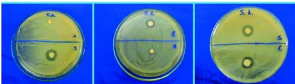
Figura 4 – Corpos de prova dos cimentos AH Plus (A), Sealer 26 (S) e Endofill (E) em contato com a cultura de *Staphylococcus aureus* (S.A.).
